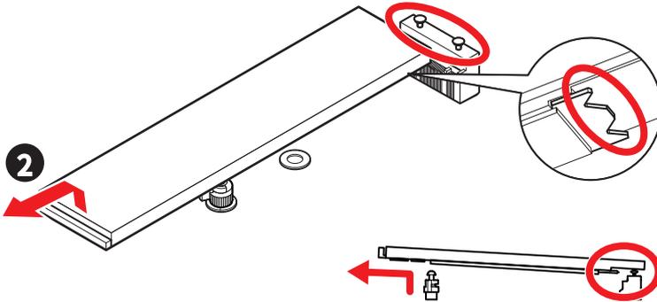
3. Wenn Sie eine 2260 SSD installieren, verwenden Sie den mitgelieferten **EZ M.2 Clip II Entferner**. Legen Sie den mitgelieferten **EZ M.2 Clip II** in den Steckplatz, verwenden Sie den Entferner, um ihn im Uhrzeigersinn einzuschrauben und zu sichern. Überspringen Sie diesen Schritt, wenn Sie eine 2280 SSD installieren.
