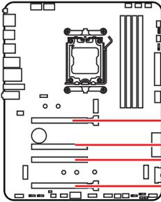
**PCI\_E1:** PCIe 5.0 x16 (von CPU)
