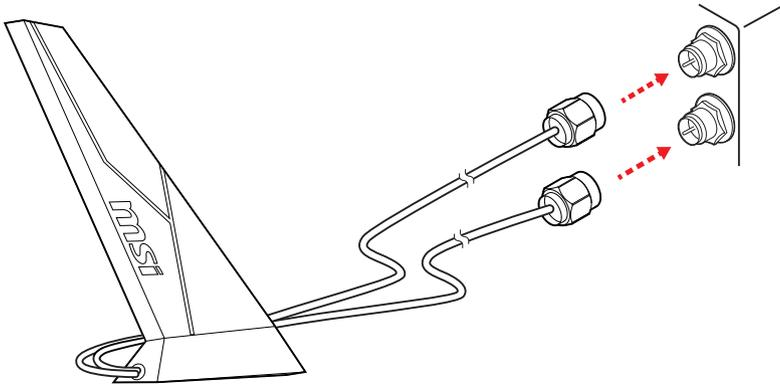
2. Positionieren Sie die Antennen für ein besseres Signal so hoch wie möglich.
