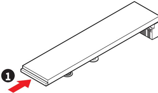
2. Heben Sie das Ende des schraublosen M.2 Shield Frozr-Kühlkörpers leicht an und bewegen Sie ihn nach vorne, um den Kühlkörper zu deinstallieren.
