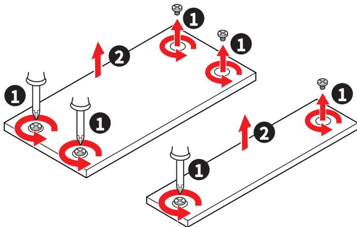
3. 2260 SSDが取り付けられている場合は、付属のEZ M.2 Clip II リムーバーを使用して付属のEZ M.2 Clip IIをネジの穴に取り付けてください。2280 SSDを取り付ける場合は、この手順をスキップしてください。
