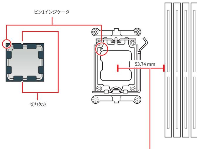
CPUソケットの中央から最近のDIMMスロットまでの直線距離。
