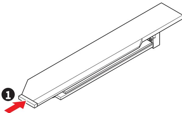
2. スクリューレスM.2 Shield Frozrヒートシンクの端を少し持ち上げ、取り外します。
