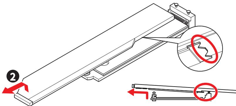
3. M.2プレートのM.2放熱パッドから保護膜を取り外します。
