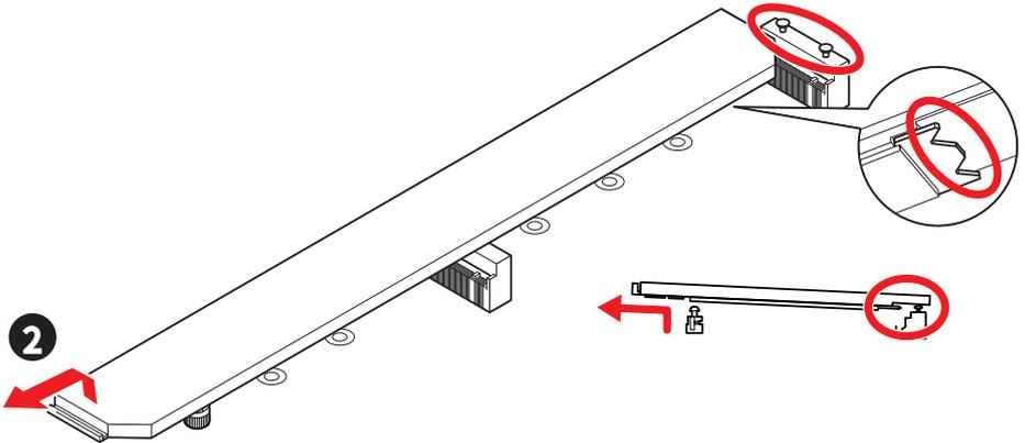
3. Legen Sie den mitgelieferten **EZ M.2 Clip II** in den Steckplatz, verwenden Sie den **EZ M.2 Clip II Entferner**, um ihn im Uhrzeigersinn einzuschrauben und zu sichern. Überspringen Sie diesen Schritt, wenn Sie eine 2280 SSD im M2\_3 Steckplatz installieren.
