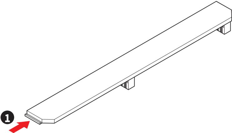
2. Heben Sie das Ende des schraublosen M.2 Shield Frozr-Kühlkörpers leicht an und bewegen Sie ihn nach vorne, um den Kühlkörper zu deinstallieren.
