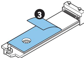
4. Wenn Sie eine 2260 SSD installieren, verwenden Sie den mitgelieferten **EZ M.2 Clip II Entferner**. Entfernen Sie die Plattenschraube und installieren Sie **EZ M.2 Clip II** im Steckplatz, indem Sie den mitgelieferten **Entferner** verwenden. Überspringen Sie diesen Schritt, wenn Sie eine 2280 SSD installieren.
