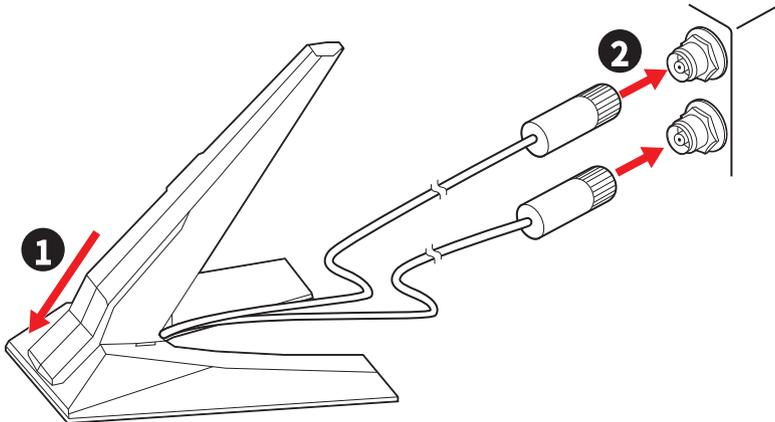
3. Positionieren Sie die Antennen für ein besseres Signal so hoch wie möglich.
