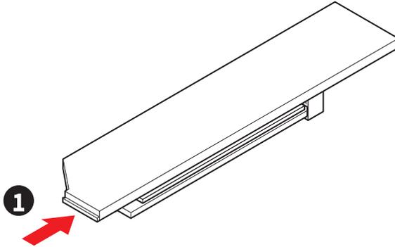
2. Heben Sie das Ende des schraublosen M.2 Shield Frozr-Kühlkörpers leicht an und bewegen Sie ihn nach vorne, um den Kühlkörper zu deinstallieren.
