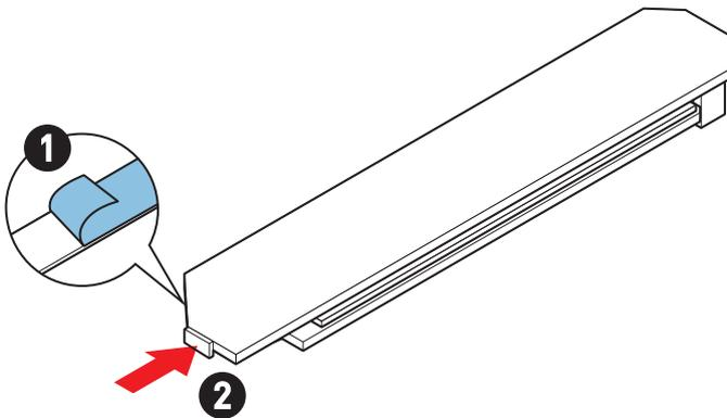
3. Soulevez légèrement l'extrémité de la plaque M.2 Shield Frozr sans vis et déplacez-la vers l'avant pour retirer la plaque.
