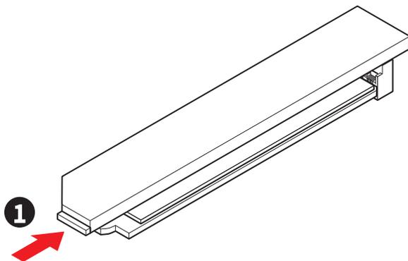
2. Soulevez légèrement l'extrémité du dissipateur M.2 Shield Frozr sans vis et déplacez-le vers l'avant pour retirer le dissipateur.
