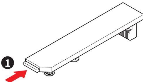
2. Soulevez légèrement l'extrémité du dissipateur M.2 Shield Frozr sans vis et déplacez-le vers l'avant pour retirer le dissipateur.
