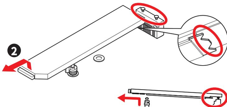
3. Si vous installez un SSD 2260, utilisez l'outil EZ M.2 Clip II Remover fourni. Placez le clip EZ M.2 II dans le slot, utilisez l'extracteur pour le visser en tournant dans le sens des aiguilles d'une montre, et fixez-le. Ignorez cette étape si vous installez un SSD 2280.
