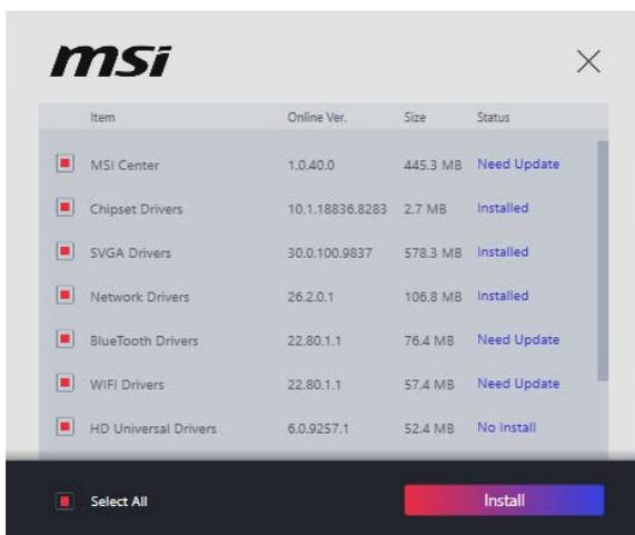
5. Выберите «**Select All**» в левом нижнем углу и нажмите **Install**, чтобы установить MSI Center и драйверы. Прогресс установки отображается внизу.
