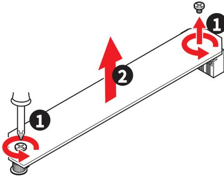
3. 如果您想安装的是 22110 M.2 固态硬盘, 请移除 2280 螺丝孔中的简易 M.2 卡扣套件。如果安装的是 2280 固态硬盘, 请跳过此步骤。
