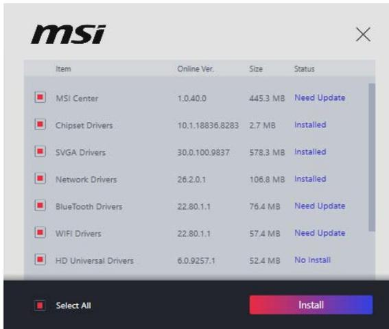
5. Aktivieren Sie das Kontrollkästchen „**Alle auswählen**“ in der unteren linken Ecke und klicken Sie auf „**Installieren**“, um MSI Center und Treiber zu installieren. Der Fortschritt der Installation wird am unteren Rand des Fensters angezeigt.
