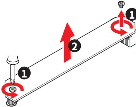
3. 如果您想安裝 22110 M.2 SSD，請取下 2280 螺絲孔中的簡易 M.2 卡扣套件。如果您安裝的 2280 SSD，請跳過此步驟。
