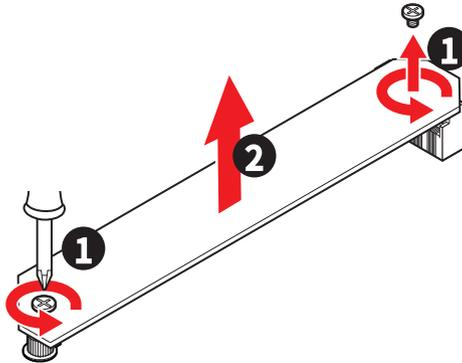
3. Wenn Sie eine 22110 M.2 SSD installieren möchten, entfernen Sie bitte das EZ M.2 Clip-Kit im 2280 Schraubenloch. Überspringen Sie diesen Schritt, wenn Sie eine 2280 SSD installieren.
