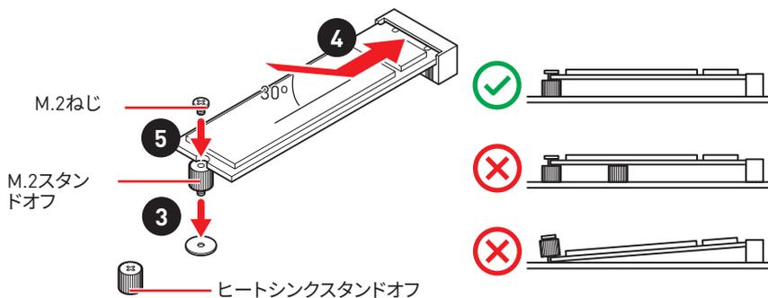
6. M.2 SHIELD FROZRヒートシンクをヒートシンクスタンドオフに固定します。
