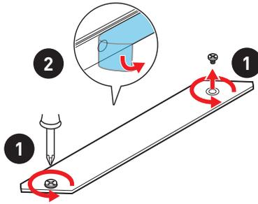
3. Entfernen Sie den M.2-Abstandshalter und befestigen Sie ihn an der entsprechenden Position Ihrer M.2-SSD. Zur Vermeidung von Schäden der M.2 SSD: Wenn die M.2-SSD dieselbe Länge wie der M.2-Steckplatz aufweist, entfernen Sie den Abstandhalter unter der M.2-SSD..
