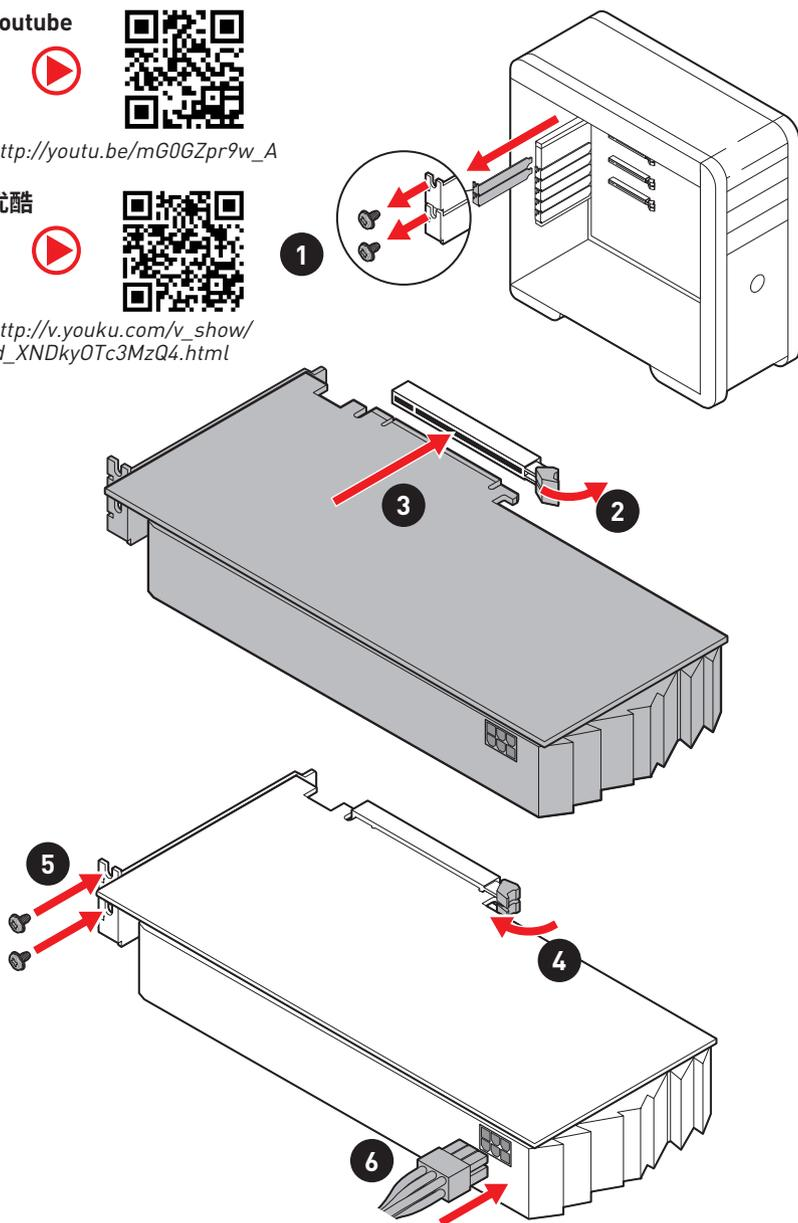
**Connecting Peripheral Devices/ Peripheriegeräte/ Connecter un périphérique anschliessen/ Подключение периферийных устройств/ 周辺機器の接続/ 주변 장치 연결하기/ 連接周邊設備/ 连接外围设备**
