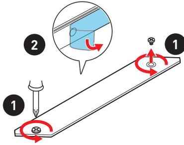
3. M.2 SSD의 길이와 M.2 히트싱크의 길이가 같을 경우, 손상 방지를 위해 M.2 스탠드오프를 M.2 SSD에 적절한 위치로 이동 및 고정하거나 M.2 스탠드오프를 제거합니다.
