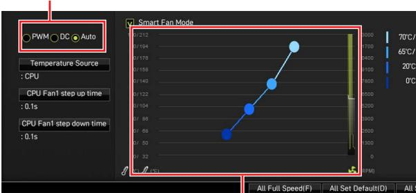
提供风扇速率渐变梯度点,允许您以 CPU 的温度来调节风扇速率。
