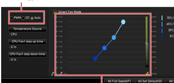
ファンスピードの傾斜ポイントはCPUの温度との関連のファンスピードを調整します。
