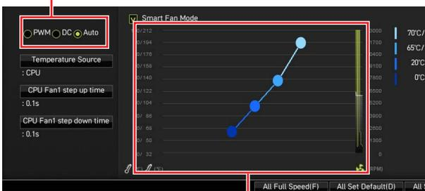
Die Gradientenpunkte des Lüfterverlaufs erlauben die Anpassung der Lüfterdrehzahl in Abhängigkeit von der CPU-Temperatur.
