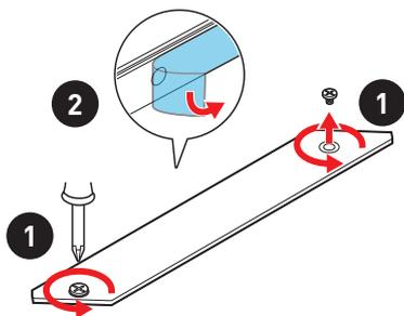
3. 請依照 M.2 SSD 的長度來移動 M.2 螺柱並鎖上,或如果您的 M.2 SSD 長度與 M.2 散熱片一樣長,請移除 M.2 螺柱以保護 M.2 SSD 設備。
