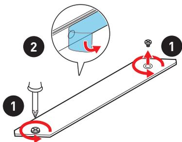
3. 将 M.2 螺柱移动并固定到 M.2 固态硬盘的适当位置, 或者, 如果 M.2 固态硬盘的长度与 M.2 散热片的长度相同, 则移除 M.2 螺柱, 以免损坏 M.2 固态硬盘。
