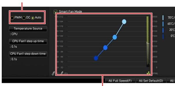
Il y a des points de gradient de la vitesse du ventilateur qui vous permet d'ajuster la vitesse de ventilateur par rapport à la température du processeur.
