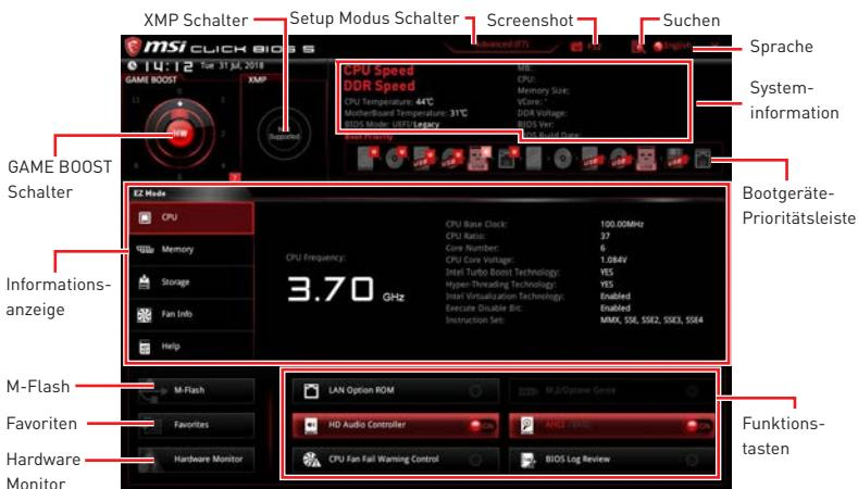
• **GAME BOOST Schalter** - Klicken Sie auf die mittlere Taste, um die **GAME BOOST** Steuerung zwischen **Software (SW)** und **Hardware (HW)** zu wechseln. Der innere Kreis zeigt den Zustand des Hardware GAME BOOST und der äußere Kreis den des Software GAME BOOST an. Sie können die Funktion des GAME BOOST nachlesen, wenn Sie auf das Fragezeichen in der rechten unteren Ecke lesen.
