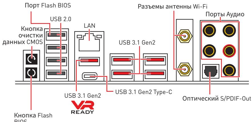
• **Кнопка очистки данных CMOS** - Выключите компьютер. Нажмите и удерживайте кнопку очистки данных CMOS на 5-10 секунд для сброса настройки BIOS по умолчанию.
