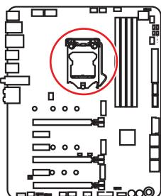
Distance entre le centre du CPU et le slot DIMM le plus proche.
