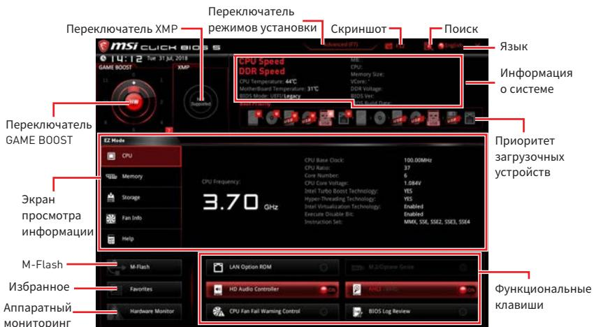
• **Переключатель GAME BOOST** - нажмите на центральную кнопку для выбора режима управления **GAME BOOST** между **программным (SW)** и **аппаратным (HW)**. Внутренняя кнопка соответствует аппаратному режиму работы функции. Внешняя кнопка соответствует программному режиму. Информацию о частоте процессора каждого уровня в режиме GAME BOOST, можно получить нажав знак **?** в правом нижнем углу.
