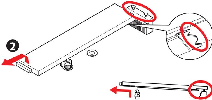
3. Wenn Sie eine 2260 SSD installieren, verwenden Sie den mitgelieferten **EZ M.2 Clip II Entferner**. Legen Sie den mitgelieferten **EZ M.2 Clip II** in den Steckplatz, verwenden Sie den Entferner, um ihn im Uhrzeigersinn einzuschrauben und zu sichern. Überspringen Sie diesen Schritt, wenn Sie eine 2280 SSD installieren.
